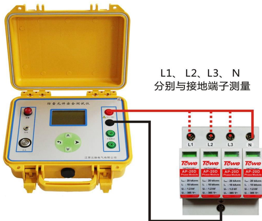
图 4 压敏电阻测试接线示意图
