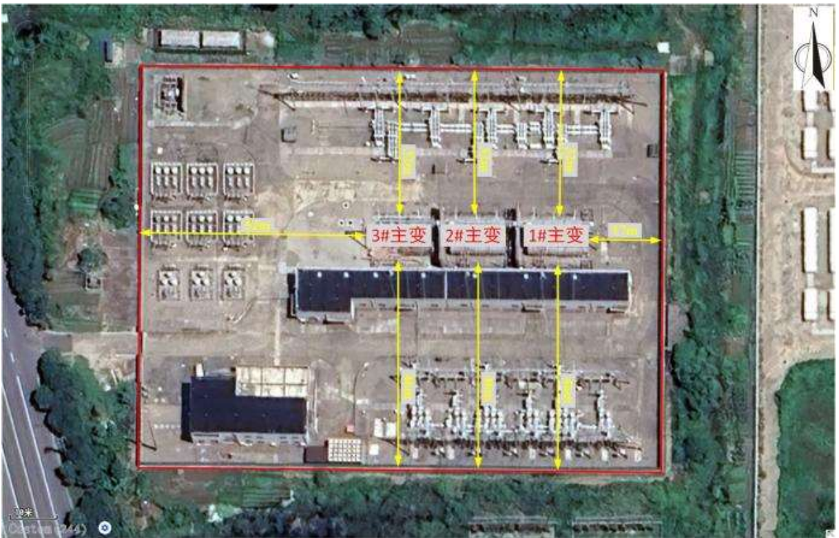
图 3 类比变电站平面布置示意图
