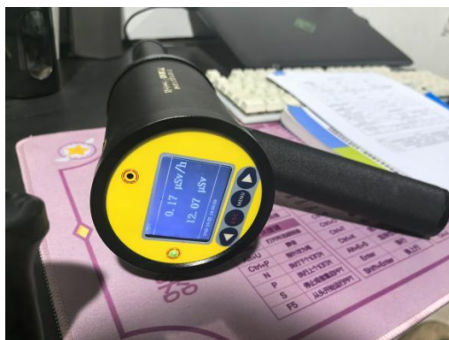
图 6 便携式 X-γ射线剂量率仪
