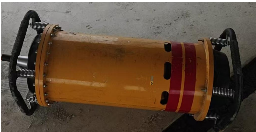
图 2-4 实际 X 射线探伤外观图
