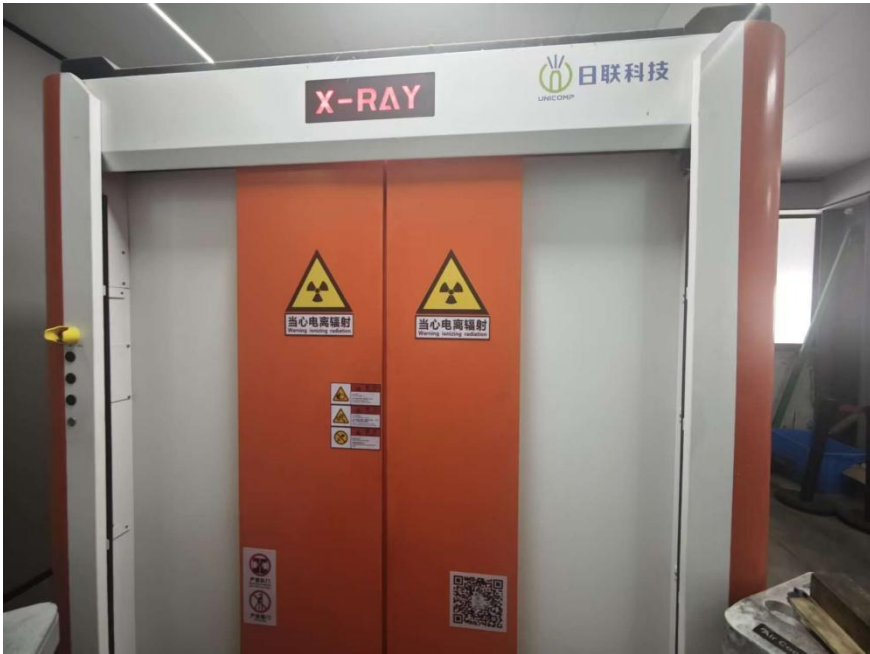
图 2-5 本项目 X 射线数字成像检测设备整体外观图
