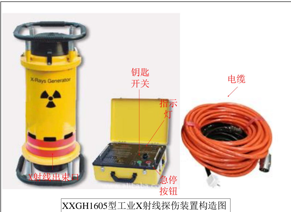
图 9-1 探伤装置设备组成图
