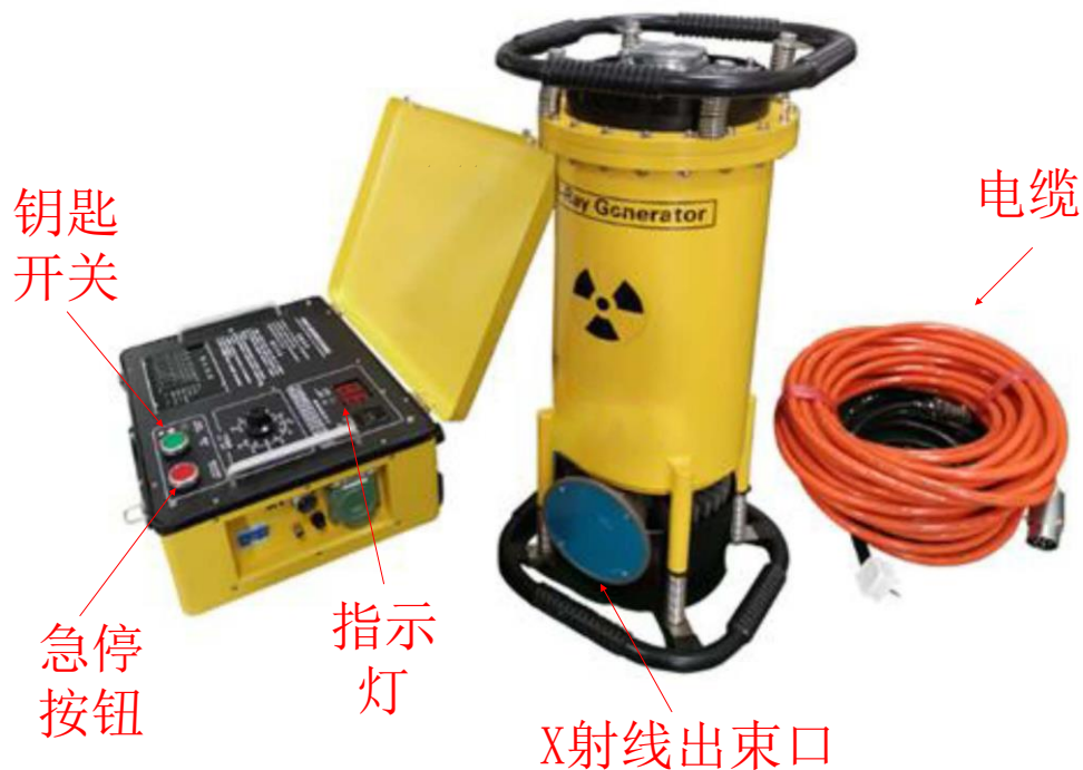
XXG1605型工业X射线探伤装置构造图
