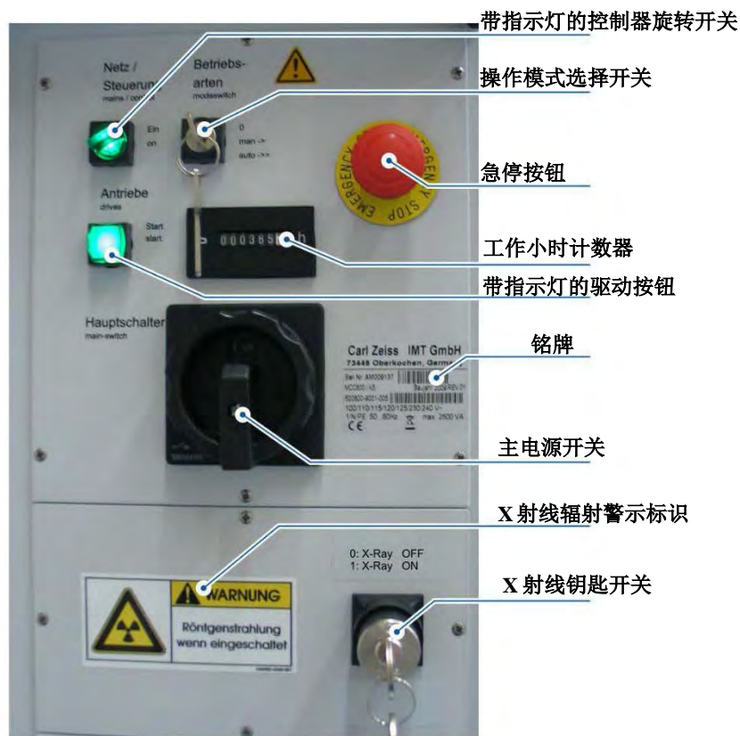
图 10-4 控制柜辐射安全与防护设施分布图
