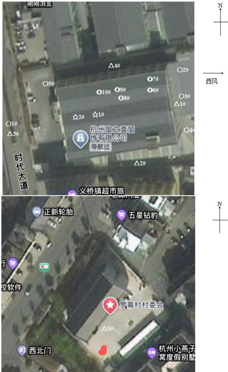
图例：☆-废水检测/采样点；◎-有组织废气采样点；○-无组织废气采样点；△-噪声检测点
