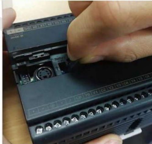
图 7 B1/B1Z 系列 32 点及其以上主机拨码开关位置以及 ON 操作方式图
