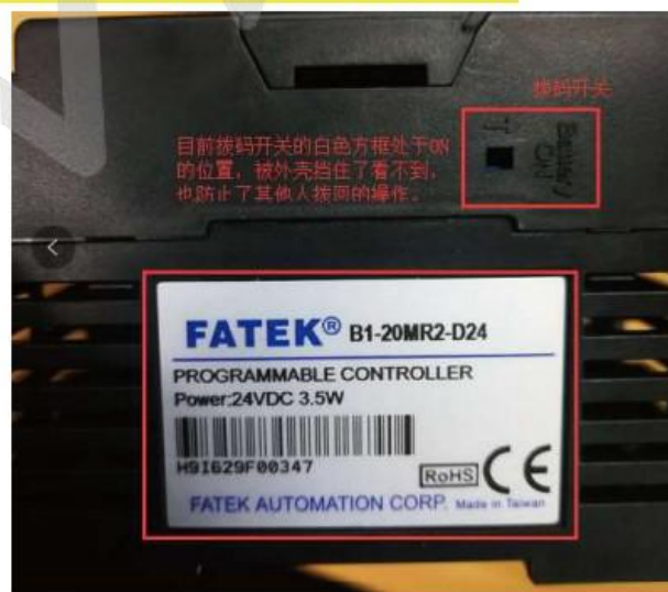
图4 B1/B1Z 系列 10-24 点主机拨码开关位置以及 ON 状态指示图
